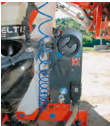
Mit dem Multifunktionshandrad und den beiden Absperrventilen ist eine einfache Bedienung ohne viele Handgriffe möglich.
