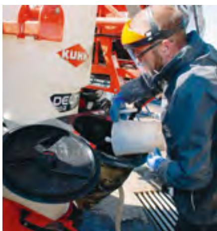
Die von Kuhn patentierte 42-Liter-Einspülschleuse «Optifiller» ist flexibel, das heisst, sie kann ein- und ausgeklappt werden.
