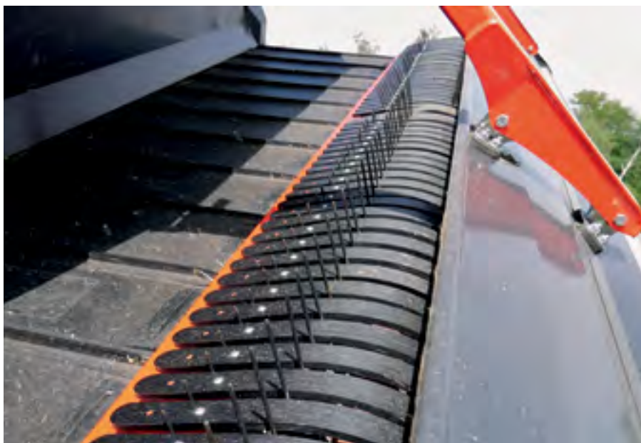
Un pick-up sans came avec des lamelles synthétiques et un tapis de convoyage renforcé par des couches textiles.
