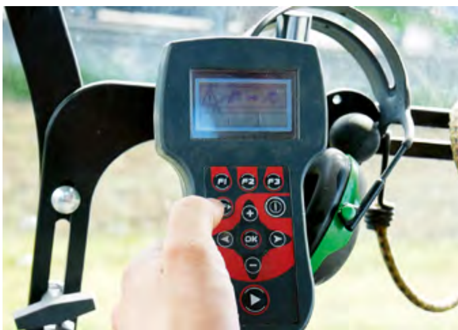
Une console simple, non compatible Isobus, sert à gérer les principales fonctions.
