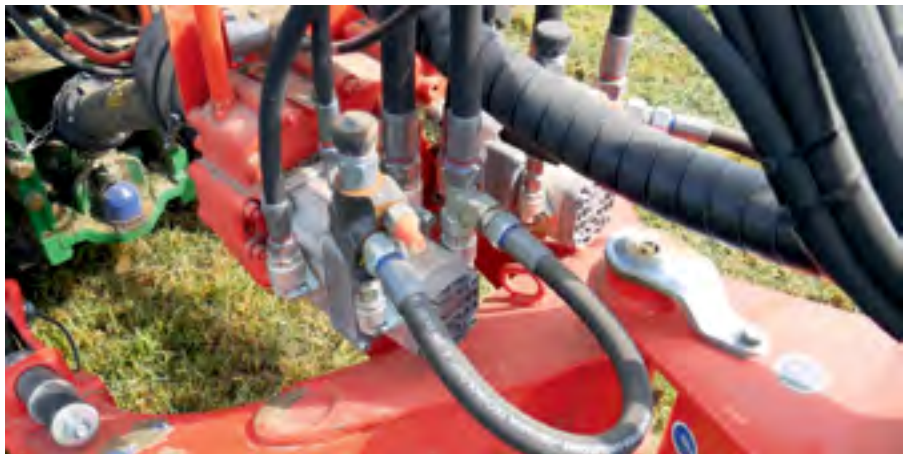
Le « Merge Maxx » est équipé d'une centrale hydraulique embarquée.
