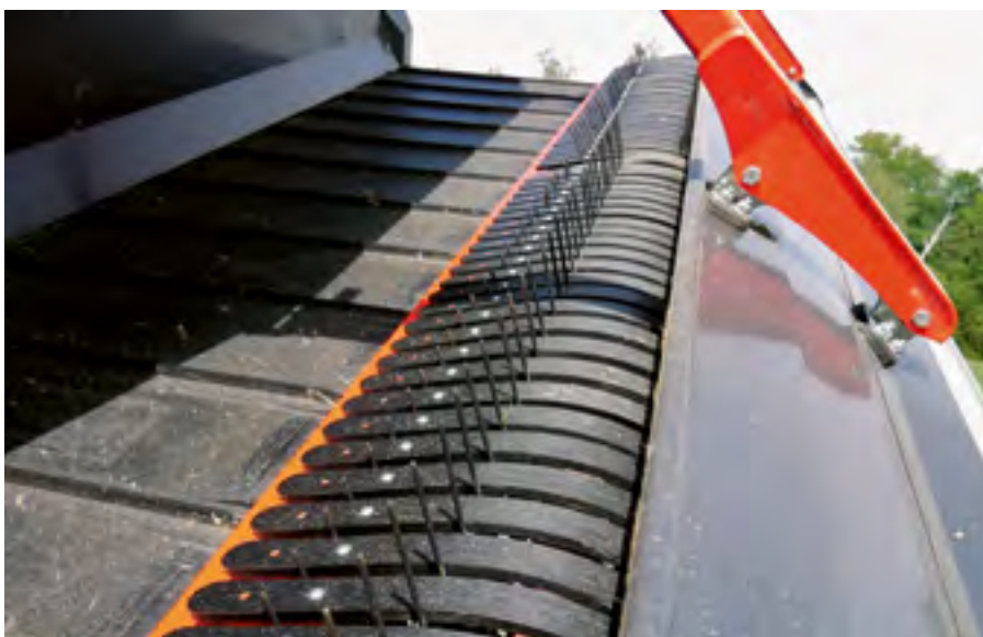
Gesteuertes Pickup mit Kunststoff-Abstreifern und das mit Gewebeeinlagen verstärkte Querrörderband.
