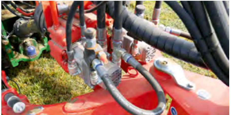
Der «Merge Maxx» verfügt über eine eigene Bordhydraulik.
