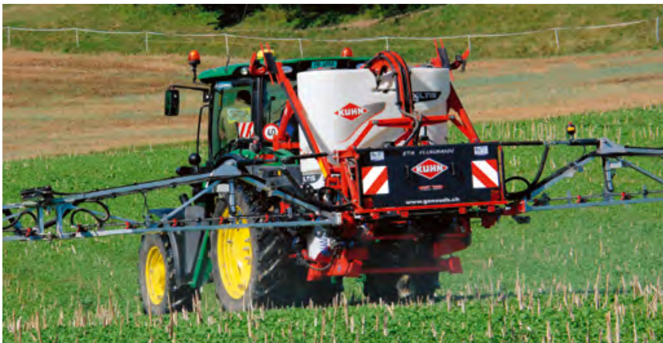
Le pulvérisateur porté « Deltis 1302 » de Kuhn utilisé par l'agro-entreprise ETA Flühmann, à Saint-Martin (FR), est équipé d'une suspension 3D de type « Equilibra ». Photos: Heinz Röthlisberger
