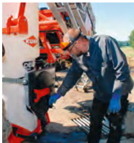
Replié, l'incorporateur est complètement adapté au gabarit du pulvérisateur et protégé contre tout risque de dommages.
