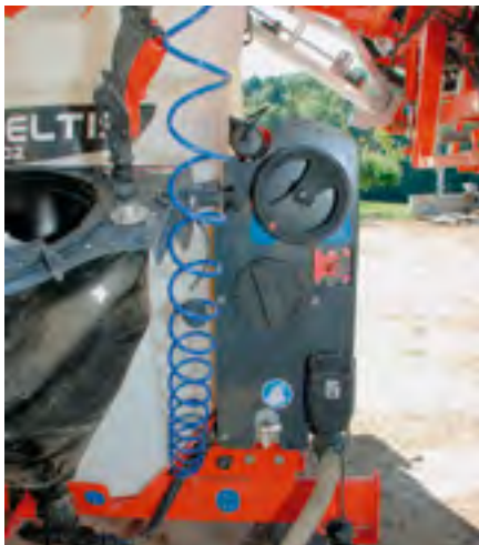
Le volant multifonction et les deux vannes d'arrêt permettent une utilisation particulièrement aisée de l'incorporateur.
