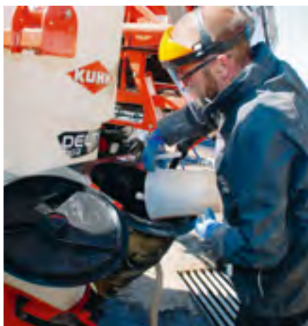
L'incorporateur « Optifiller » breveté de 42 litres est escamotable. Sa large ouverture facilite les opérations d'incorporation.
