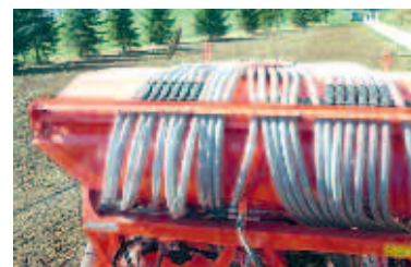
La tête de distribution est située sur la trémie et reste accessible lorsque cette dernière est pleine.
