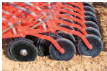
«Seedflex» se compose de deux rangées décalées de disques doubles distant de 35 cm.
